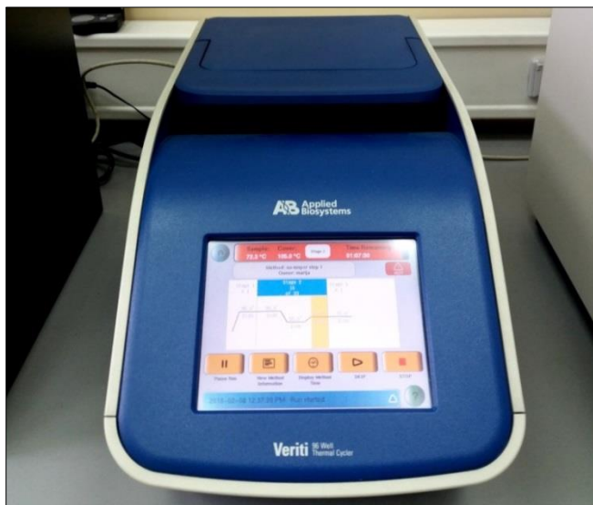
Slika 11. PCR mašina za konvencionalni PCR (Veriti Thermal Cycler, Applied Biosystems™) na kojoj su vršene analize u ovoj studiji
