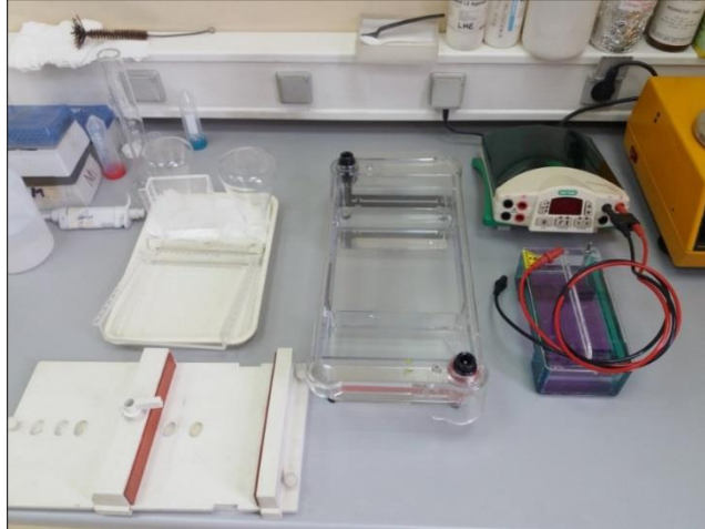
Slika 12. Sistem za horizontalnu gel elektroforezu ( Sub-Cell, GT, Bio-Rad TM ) korišćen u toku eksperimentalnog rada
